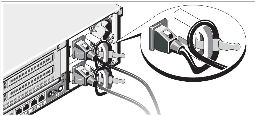
Sangkutkan braket penahan kabel daya di arah lekukan kanan gagang catu daya. Tekuk kabel daya sistem secara melingkar seperti ditunjukkan pada gambar kemudian kencangkan kabel dengan pengikat kabel braket.
