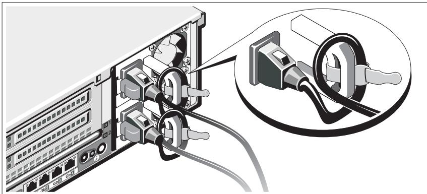
電源ケーブル固定プラケットを電源ユニットハンドルの右ベンドに取り付けます。システムの電源ケーブルをループ状に曲げ（図を参照）、プラケットのケーブル留め金に取り付けます。
