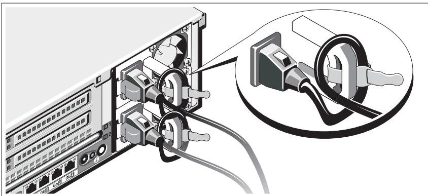
전원 공급 장치 핸들의 오른쪽 벤드에 전원 케이블 고정 브래킷을 연결합니다. 그림과 같이 시스템 전원 케이블을 고리 안으로 구부려서 브래킷의 케이블 결쇠에 연결합니다.
