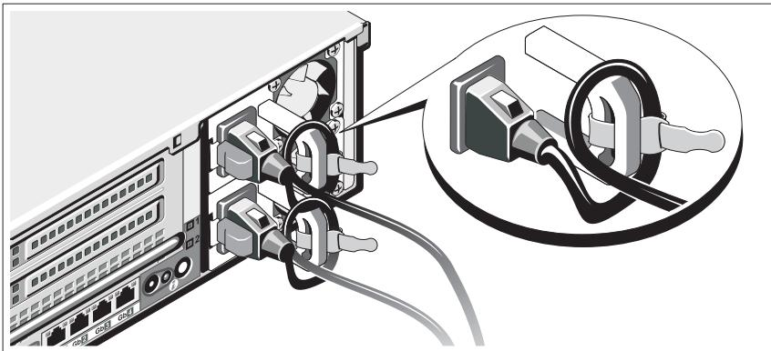
在电源设备手柄的右侧拐弯处上方连接电源电缆固定支架。如示意图所示，将系统电源电缆弯曲成环状，并连接至支架的电缆挂钩。
